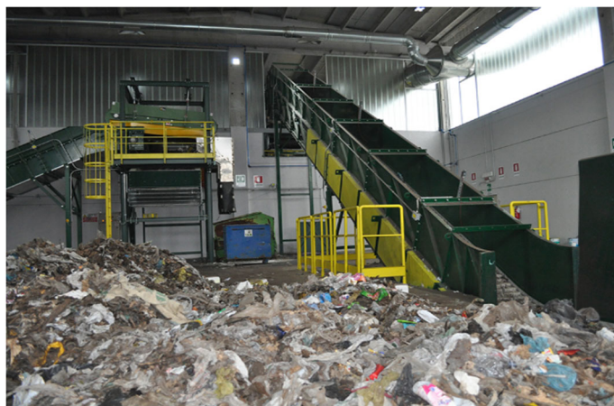
Figura 1- Impianto triturazione e abbancamento rifiuti in discarica
