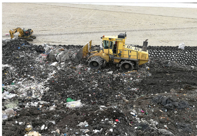
Figura 1- Impianto triturazione e abbancamento rifiuti in discarica
